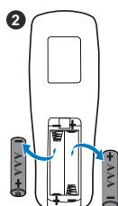
3 按照电池仓中的标记装入电池以确保极性正确。
